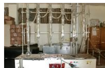
すっかりホコリをかぶったアリーン冷却器と蒸留装置
