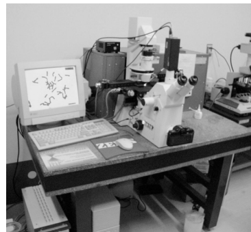
(左) T-DNAタギングにより得られたシロイヌナズナの斑入り突然変異体 var2-6 。(右) 染色体の切り出しに用いるレーザーマイクロダイセクション装置。
